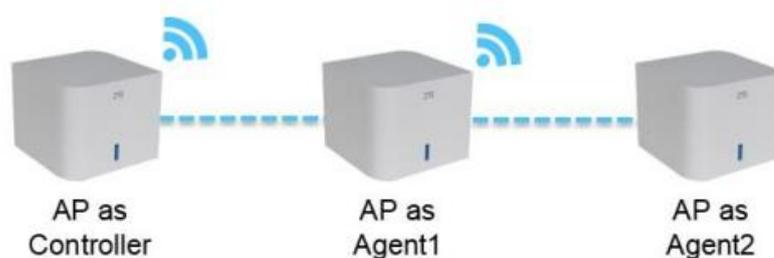
1. Restaure o Controlador para as configurações de fábrica e configure as bandas em 2,4 GHz e 5 GHz. Em seguida, ligue o Agent1 e o Agent2 e restaure-os para as configurações de fábrica.
